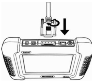
Рисунок 3-2. Подключение главного кабеля к сканеру
