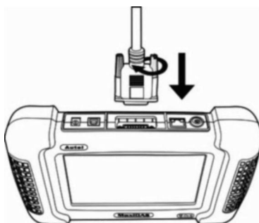
Рисунок 3-5. Подключение главного кабеля к сканеру
