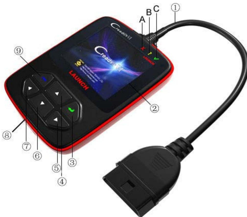
1. **Кабель с OBDII разъемом** – соединяет CreaderVI диагностическим разъемом (DLC) автомобиля.
